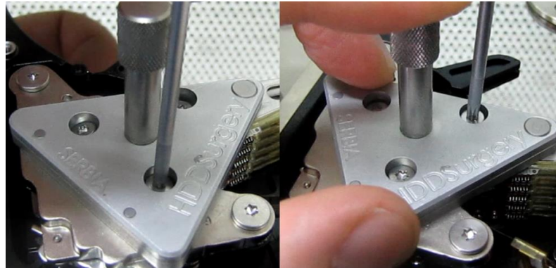
그림 8.12 (헤드와 가장 윗부분에 있는 마그넷으로부터 서포트 툴 나사 분리)
