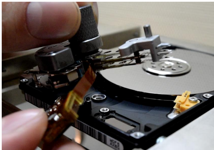
Picture 6.14 (서포트 툴을 사용하여 Donor 드라이브로부터 헤드 및 마그네틱 마운팅을 해제합니다.)
