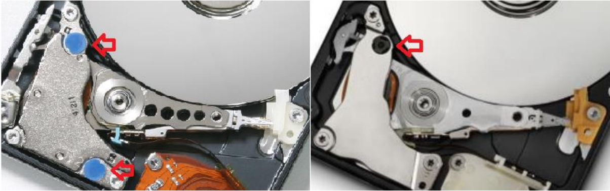
Picture 4.2 (왼쪽- 위쪽에 있는 마그네틱에 2 개의 안전 브레이크가 있는 Hitachi 2.5" 하드 드라이브, 오른쪽 - 위쪽에 있는 마그네틱에 1 개의 안전 브레이크가 있는 HDD)
