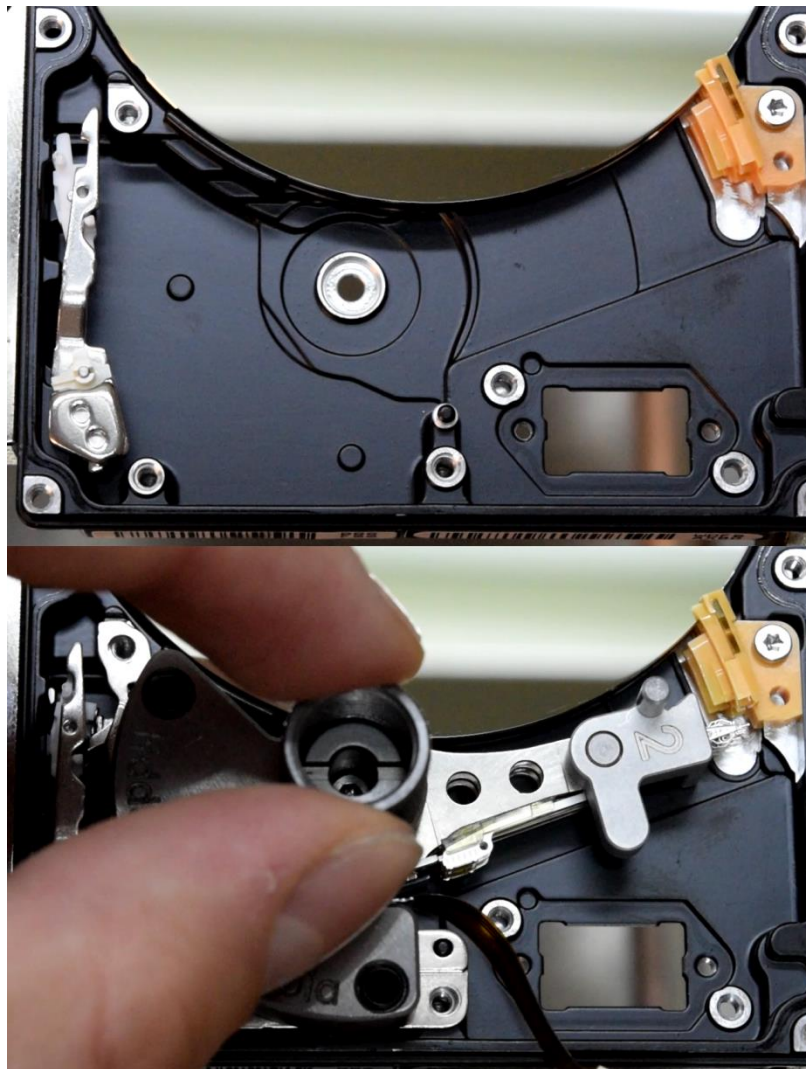
Picture 6.15 (위 – 손상 드라이브, 아래 – 손상 드라이브에 헤드 및 마그네틱 마운팅하기)
